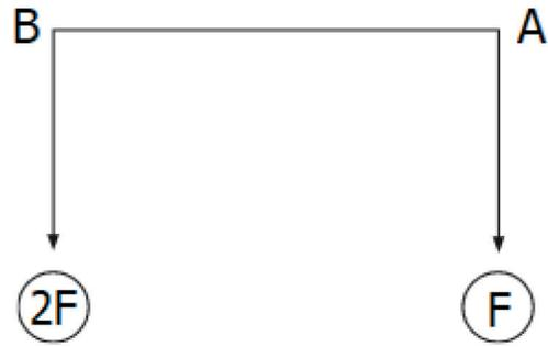
Deux forces parallèles et de même sens  $F$  et  $2F$  agissent aux points A et B respectivement tel que  $AB = 6\text{cm}$ . Si les deux forces sont remplacées l'une de l'autre.
